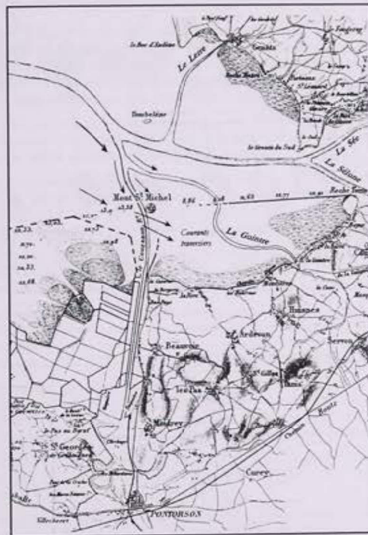
Fig. 3: Configuration des rivières en 1878 dans la partie estuarienne de la baie (d'après plan Ec. Ponts et Chaussées 1880 modifié)
