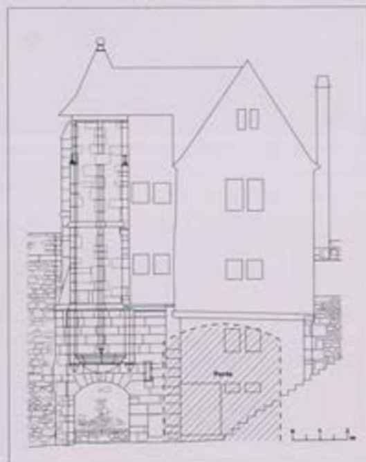
Figure 7 - Relevé de la porte conservée dans la Maison de l'Arcade. Relevé : F. Boumier, INRAP, Graphim.
